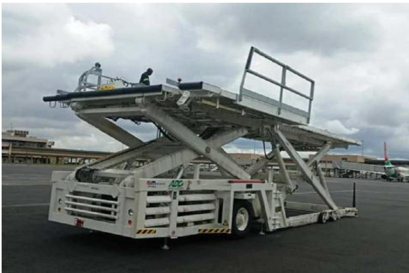
Le « Loader » est capable de décharger des charges de 27 tonnes. Avec cet équipement de pointe, La société ADC S.A peut désormais traiter des cargos ayant ce type de charge.
